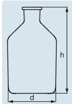
Une température maximale en utilisation de + 100 °C est recommandée. Résistance aux chocs thermiques 30 K. Classe hydrolytique 3. Remarque sur l'utilisation de bouchons en verre DURAN® sur les flacons en verre sodocalcique : les bouchons en verre peuvent se bloquer dans les cols des flacons en présence de différences de températures de plus de 30 °C!
